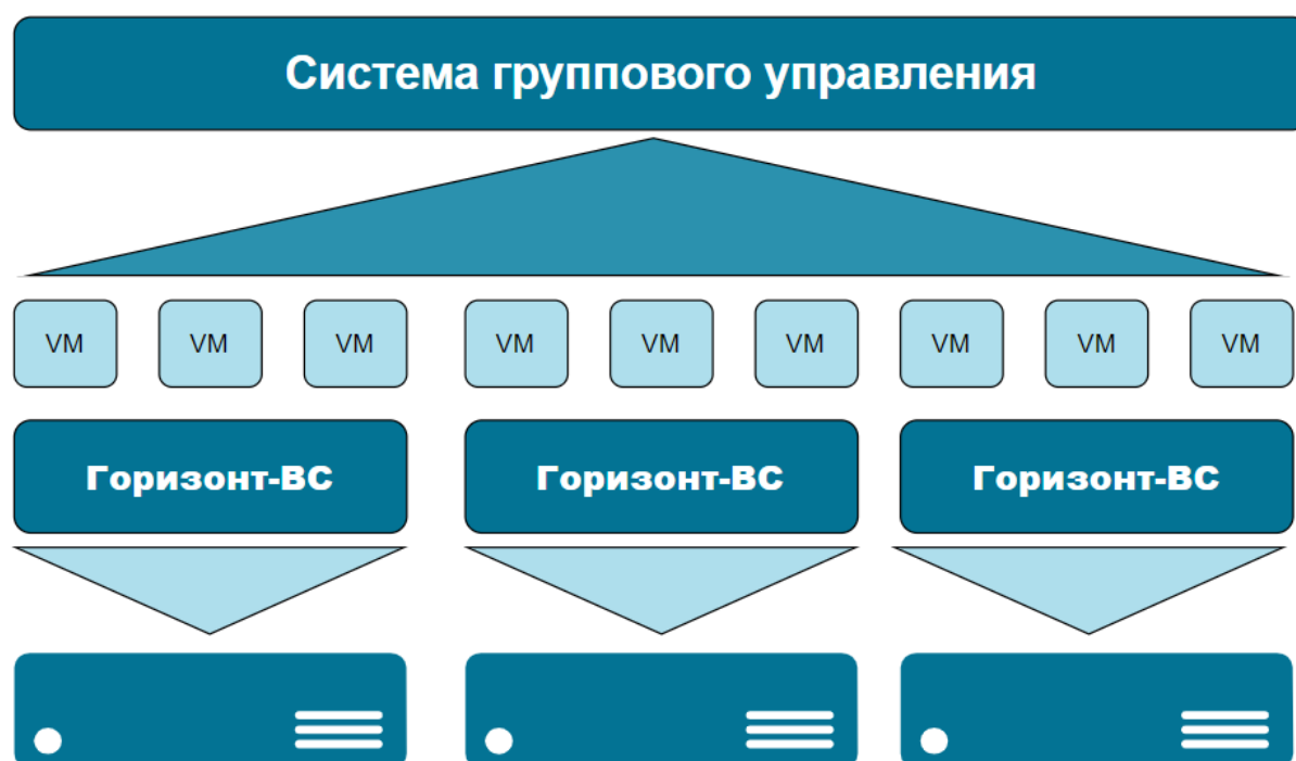
Рисунок 43 – Структура работы системы группового управления Горизонт-ВС
