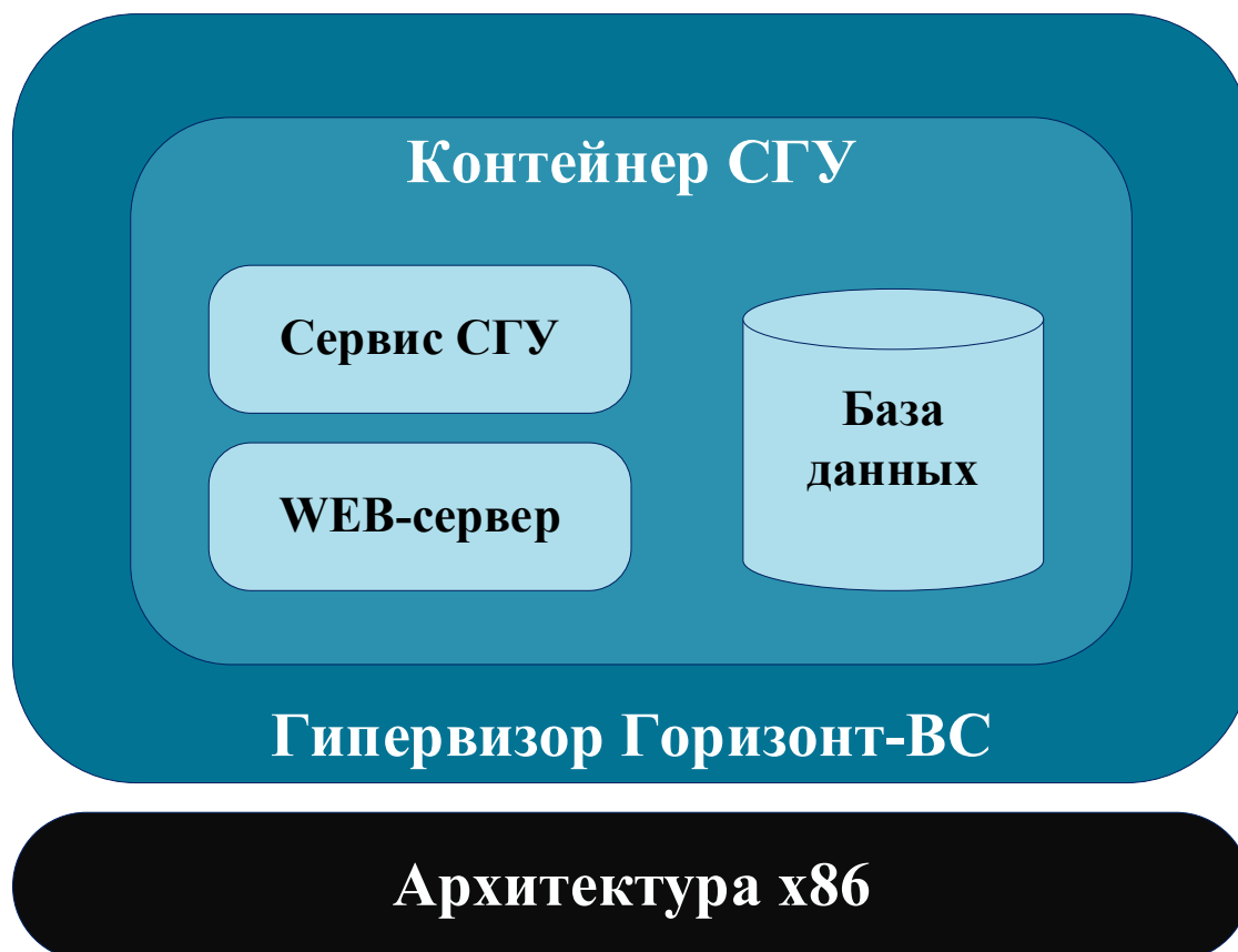
Рисунок 44 – Структура контейнера СГУ
